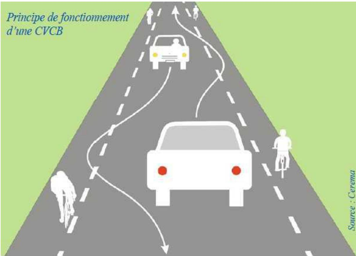
La Chaussée à Voie Centrale Banalisée (CVCB) est une chaussée étroite sans marquage axial dont les lignes de rive sont rapprochées de son axe. Les véhicules motorisés circulent sur une voie centrale bidirectionnelle et les cyclistes sur la partie revêtue de l'accotement appelée rive. La largeur de la voie ouverte aux véhicules motorisés est insuffisante pour permettre le croisement, ces derniers empruntent donc la rive lorsqu'ils se croisent, en vérifiant auparavant l'absence de cyclistes.
